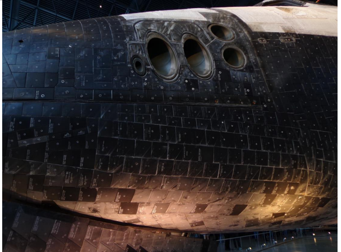
Uzay mekiğinin alt kısmında yer alan ve mekiği yüksek sıcaklıklardan koruyan yalıtkan tuğlalar.
